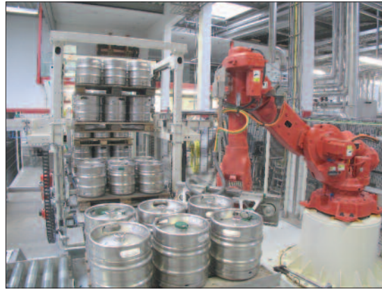
Bild links: Die Prozessautomatisierung ermöglicht ein perfektes Zusammenspiel der Anlagenkomponenten. Brauerei 4.0 liefert dazu ein strukturiertes Plant-Asset-Management (PAM); Bild rechts: Brauerei 4.0 in der Fassabfüllung: vollautomatisch dank Roboter, RFID-Transpondern an den Fässern und deren intelligente Kodierung und Bedruckung
