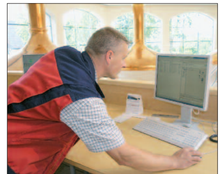
Bild links: Mitte der 1980er Jahre: Tankfüllstände werden per Rackbus-System am Computer-Bildschirm visualisiert. Heute: Zustandsinformationen aus der Feldgeräteebene können mithilfe der FieldCare-Software von dezentralen Operator-Stationen abgerufen werden. (Bild rechts)
