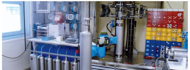
**Étalonnage de la pression** Vos appareils de mesure de pression sont étalonnés très précisément dans le laboratoire d'Endress+Hauser, dans le respect le plus strict des spécifications. L'étalonnage est effectué à des points de mesure uniformément répartis sur toute la gamme d'étalonnage. En fonction de l'incertitude de mesure souhaitée, une ou plusieurs séries de mesures sont effectuées.
