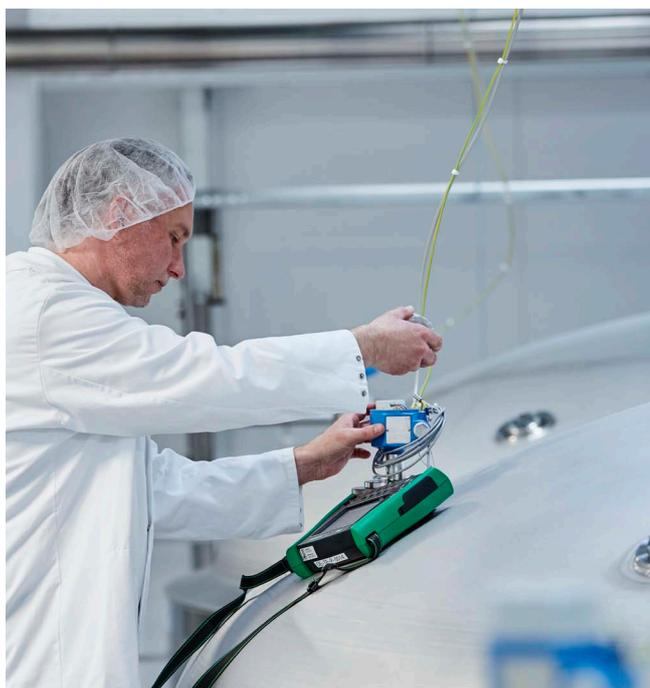
**i Etalonnage** Détermination et documentation de la différence entre la valeur affichée et la valeur considérée comme correcte. Les moyens de contrôle utilisés à cette fin sont traçables et font l'objet d'une surveillance constante.
