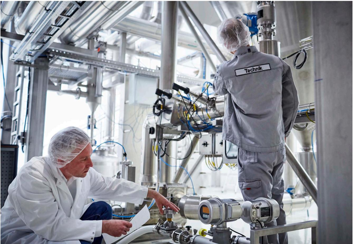
L'étalonnage accrédité du débit sur site selon ISO/IEC 17025 à l'aide des chariots d'étalonnage mobiles réduit les interruptions du process et augmente la disponibilité de l'installation.
