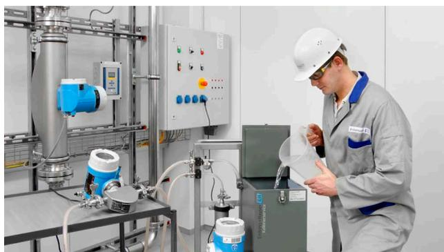
Endress+Hauser propose une procédure d'étalonnage sur site de la masse volumique – par exemple de débitmètres massiques Promass.
