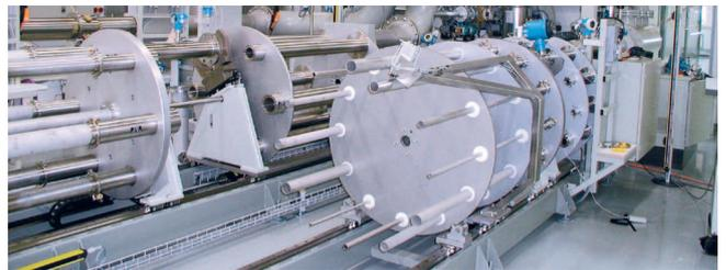
**Étalonnage spécial de la densité** Sur demande, Endress+Hauser vous propose un étalonnage pour la densité, mené dans un laboratoire spécial. Des liquides de différentes densités (de 0.8 g/cc à 1,8 g/cc) sont alors utilisés. En comparant les variations de densité, on peut déterminer des précisions de mesure de l'ordre  $\pm 0.0005$  g/cc.
