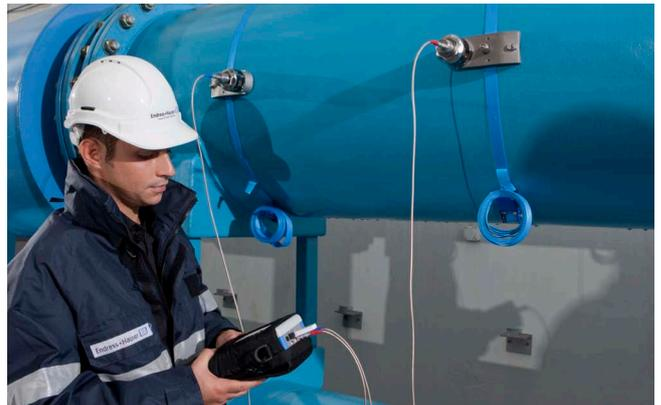
Débitmètre à ultrasons clamp-on : mesure comparative sans interruption du process.
