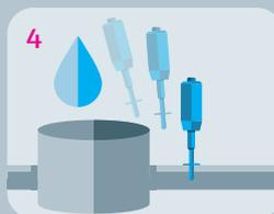
**Remontage, nettoyage** Après le remontage du capteur, l'installation doit souvent être stérilisée. Ce n'est qu'après cela que la production peut redémarrer.
