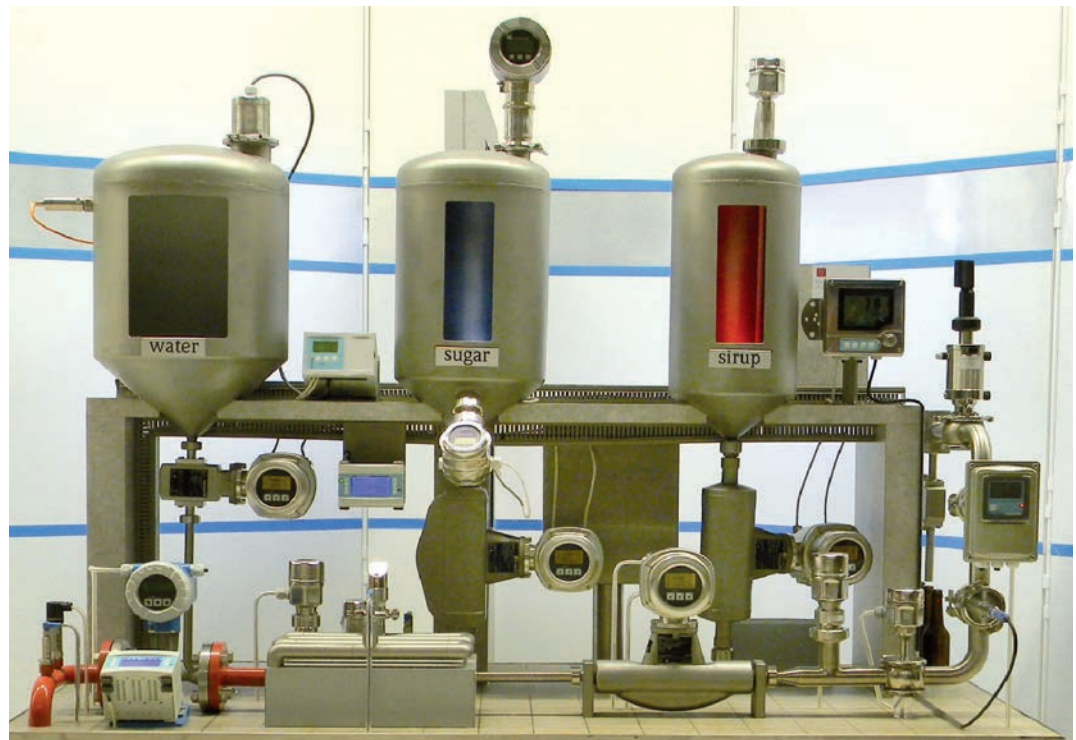
Bei dieser Ausmischanlage werden durch die optimale messtechnische Bestückung neben der Durchflussmenge auch die Dichte und die Temperatur des Produkts ermittelt
