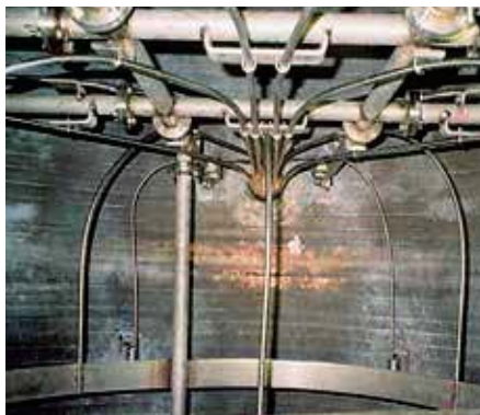
Octopus-Systeme zur dreidimensionalen Messung im Reaktor
