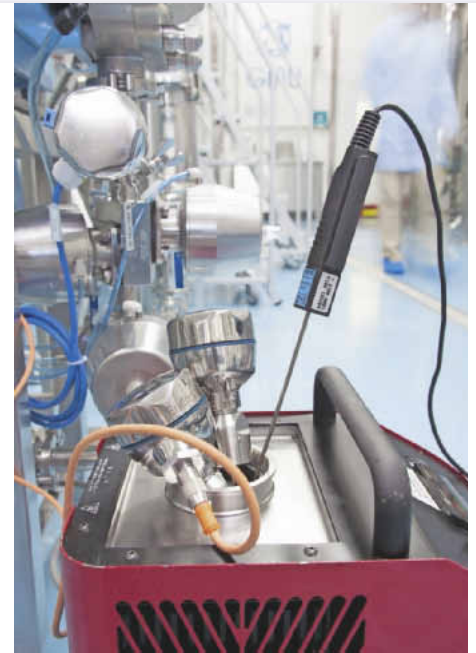
Bild 3: Temperaturkalibrierung im Ölbad mit TM411-QuickNeck-Anschluss ermöglicht werkzeugfreie Demontage. Mit TM411-QuickSens-Messeinsatz können kurze Eintauchlängen konform zur ISO 17025 realisiert werden.
