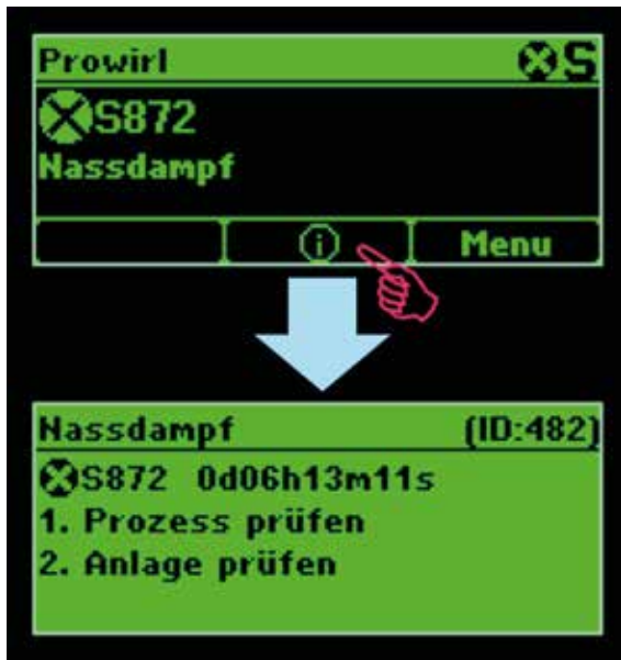
04 Wird am Prowirl F 200 die Funktion „Nassdampferkennung“, die als Grenzwertalarm arbeitet, ausgewählt, erscheint im Display bei einer Dampfqualität von 80 % eine Alarmmeldung
