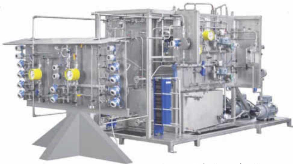
Im automatischen Sperrmedium-Versorgungssystem AVS von Ekato Systems zeigen Druckmessgeräte Cerabar S einen Druckabfall schnell und präzise an und verhindern so gefährliche Situationen Bild: Ekato
