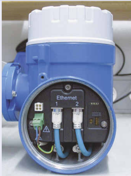
Mit Industrial Ethernet und integriertem Webserver werden Feldgeräte von Endress+Hauser nahtlos in die IT-Welt integriert
