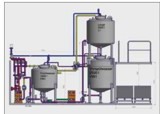
Die Konstruktionszeichnung diente dem Projektteam als Vorschau (Bild: Gebr. Rieger)
