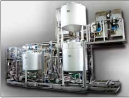
Um kurze Umstellzeiten bei Mars einzuhalten, wurde die Anlage fertig montiert geliefert (Bild: Gebr. Rieger)
