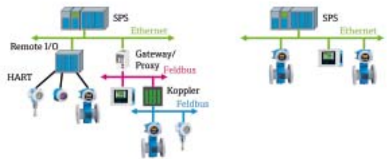
Aufwand der Einbindung von Feldgeräten: links über Remote I/O, Gateways oder Koppler; rechts über Ethernet ohne zusätzliche Komponenten
