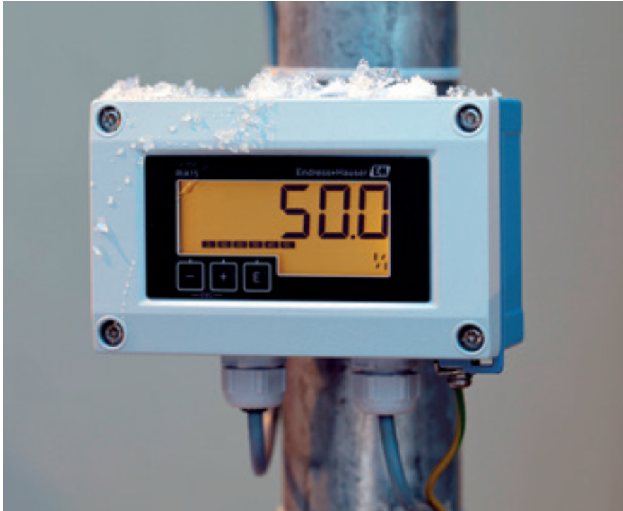
01 Der Hart-Anzeiger RIA15 von Endress+Hauser eignet sich auch für den Einsatz in rauen Umgebungen
