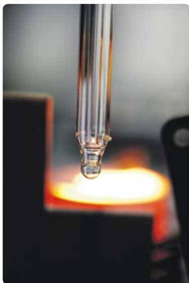
Abb. 1: Die hochspezialisierte Fertigung von pH-Sensoren für die Memosens-Technologie ist aus der traditionellen Glasbläserkunst hervorgegangen. Heute wird die Glaskugel nach dem Anschmelzen vollautomatisch aufgeblasen. Auch die Abfüllung der Qualitätspuffer im DAKKS-akkreditierten Labor erfordert Know-How und hohe Zuverlässigkeit.
