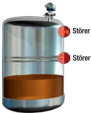
Durch „Multi-Echo-Tracking“ werden bis zu 20 Störsignale unterschieden
