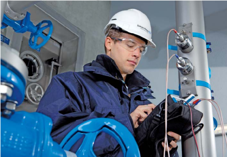
Abb. 3: Schnelle Überprüfung von Durchflussmessgeräten mit US Clamp-On Prosonic Flow 93T.
