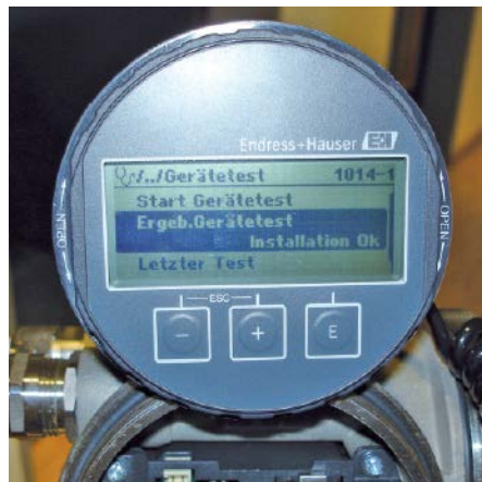
Abb. 4: Integrierte Geräteprüfung beim Levelflex FMP5x.
