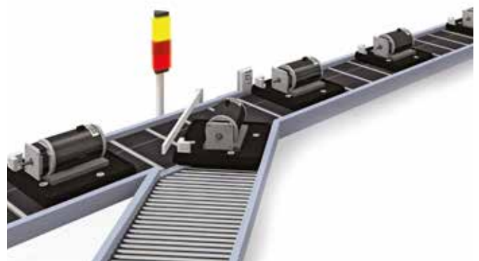
Rückverfolgbarkeit und Error Proofing mit RFID
