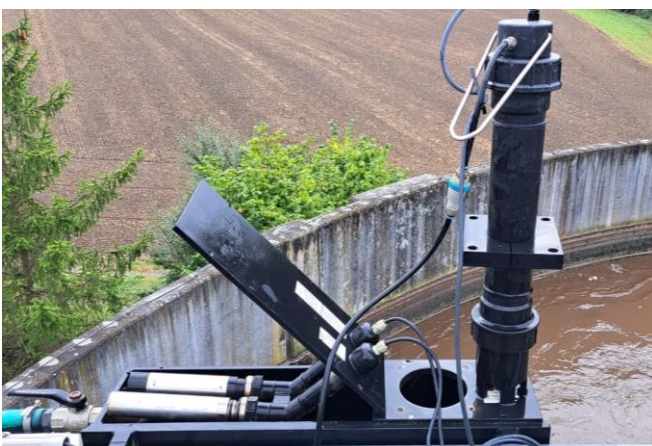
Fig. 3 : Bassin de mesure dans l'un des trois réacteurs SBR avec la sonde sélective d'ions (à droite) et les sondes pour la teneur en matière sèche, le pH et la concentration en oxygène dissous (à gauche).
