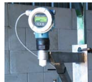
Füllstandmessung in der Beschickung mit Ultraschall: Prosonic M
